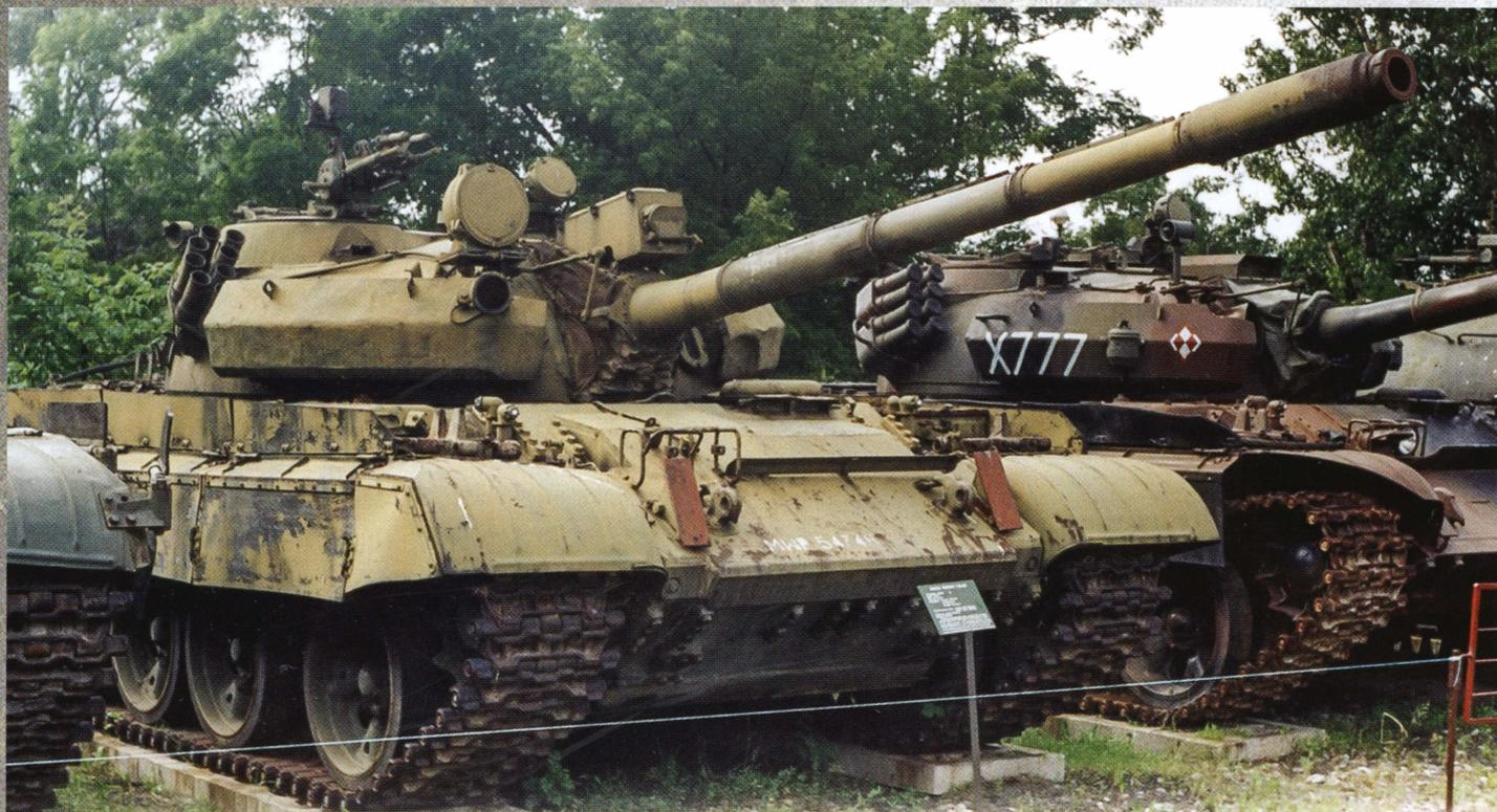
Танк Т-55АМ польского производства, 1997 год. Хорошо видна дополнительная бронезащита на лобовом листе корпуса и передней части башни. Пушка оснащена теплозащитным кожухом.
