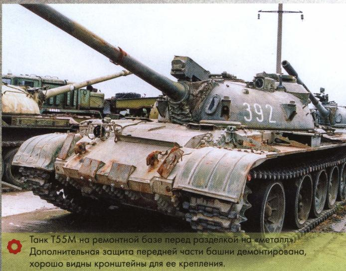
Танк Т55М на ремонтной базе перед разделкой на «металл». Дополнительная защита передней части башни демонтирована, хорошо видны кронштейны для ее крепления.
