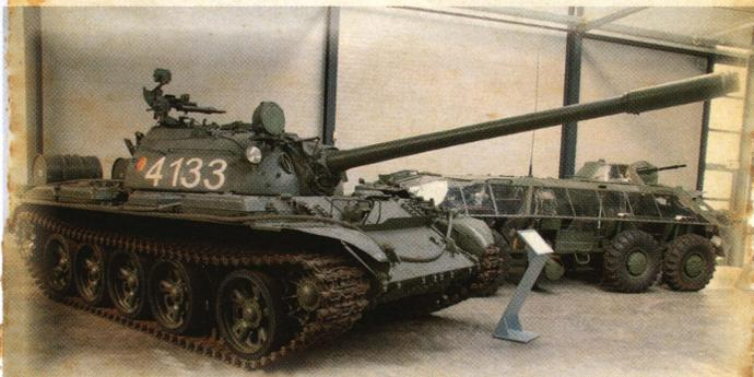
Танк Т-55А Национальной народной армии ГДР. Машина оснащена двумя дополнительными бочками с топливом, закрепленными на корме.
