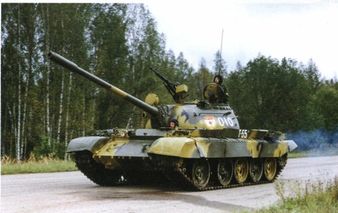
Танк Т-55А, 2001 год. Хорошо видна зенитная установка 12,7-мм пулемета ДШКМ.
