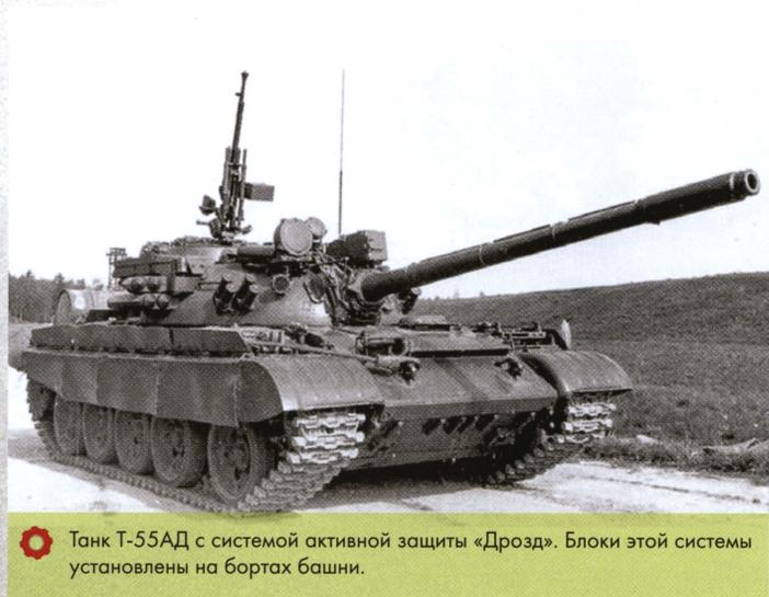
Танк Т-55АД с системой активной защиты «Дрозд». Блоки этой системы установлены на бортах башни.
